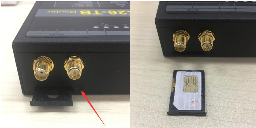
使用尖状物轻顶退卡钮，将 SIM 卡放入卡槽
